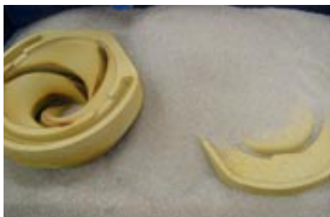
Fenolhartsbunden sand sintras i tunna skikt av en laser och formen byggs upp lager för lager.
