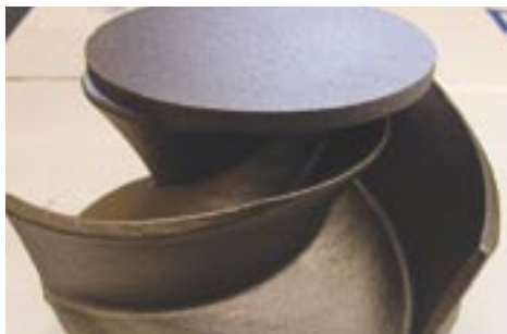
Friformsframställning passar bäst för komplexa kärnor och formar för metall detaljer som ska sandgjas.
